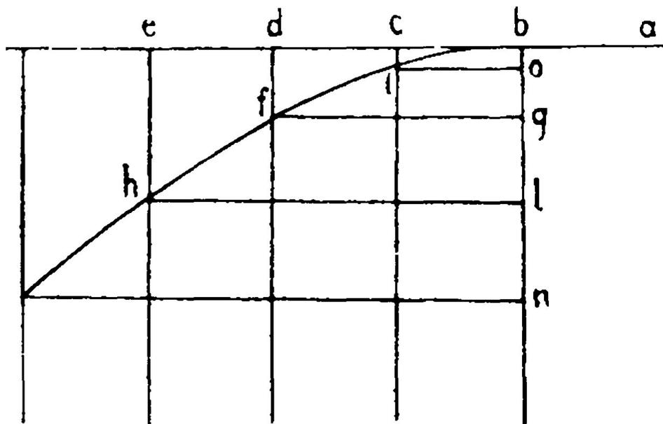
Откладывая по горизонтальной прямой равные отрезки расстояний, проводимых точкой в каждую единицу времени (*из-за того, что импульс к падению на такой прямой равен нулю*), затем откладывая на отвесной, направленной вниз полуоси отрезки расстояний, проводимые в каждую единицу времени в *равноускоренном движении*, Галилей доказал, что **баллистическая пустотная кривая - полупарабола**, а для движения тяжелых тел, брошенных под углом к горизонту **парабола**, состоящая из двух симметричных ветвей.
