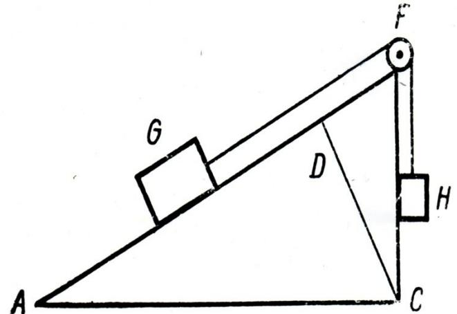
**«момент скорости тела» (т.е. ускорение) вдоль данной наклонной плоскости обратно пропорционален длине плоскости**
