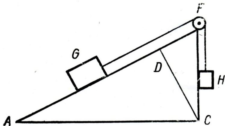
Если перерезать нить  $GF$ , то тело  $G$  будет двигаться равноускоренно по гладкой наклонной плоскости  $FA$ . Так как импульс тела (или его стремление) к падению «столь же велик» как сила, способная его остановить, то в качестве этой силы можно взять тяжесть противовеса  $H$ , уравновешивающего груз  $G$  с помощью нити  $GFH$ .
