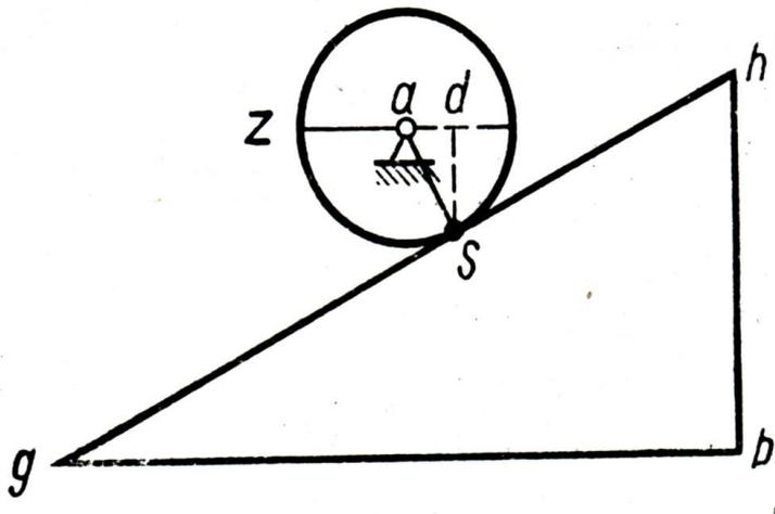
Зная количественную меру относительной тяжести груза на конце ломанного рычага, Галилей вычисляет относительную тяжесть груза **S** на наклонной плоскости.
