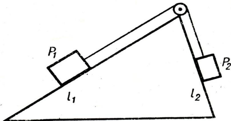
Задача о равновесии и движении грузов по наклонной плоскости.
