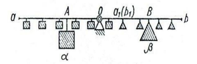
Полученный однородный стержень эквивалентен исходному неравноплечному рычагу *AB*, т.к. по *Теореме 4* операции рассредоточения грузов α и β не могли нарушить состояния равновесия исходного рычага, то исходный рычаг *AB* также находится в равновесии.
