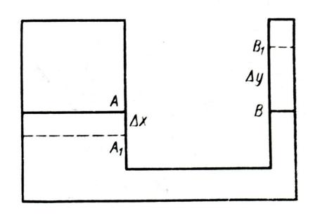
Представим себе сообщающийся сосуд с широкой и узкой трубками, закрытыми поршнями А и В соответственно. Каково соотношение весов поршней при равновесии несжимаемой жидкости в сосуде?
