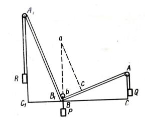
Запишем пропорциональность трех грузов, уравновешенных на нитях под прямым углом, получаем:
