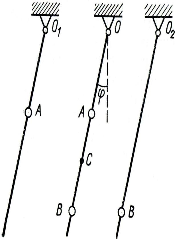
В составном маятнике наблюдается своеобразная передача количеств движений: груз  $A$ , более близкий к точке подвеса ускоряет колебание более далекого груза  $B$ , этот же последний замедляет колебание верхнего груза  $A$ .
