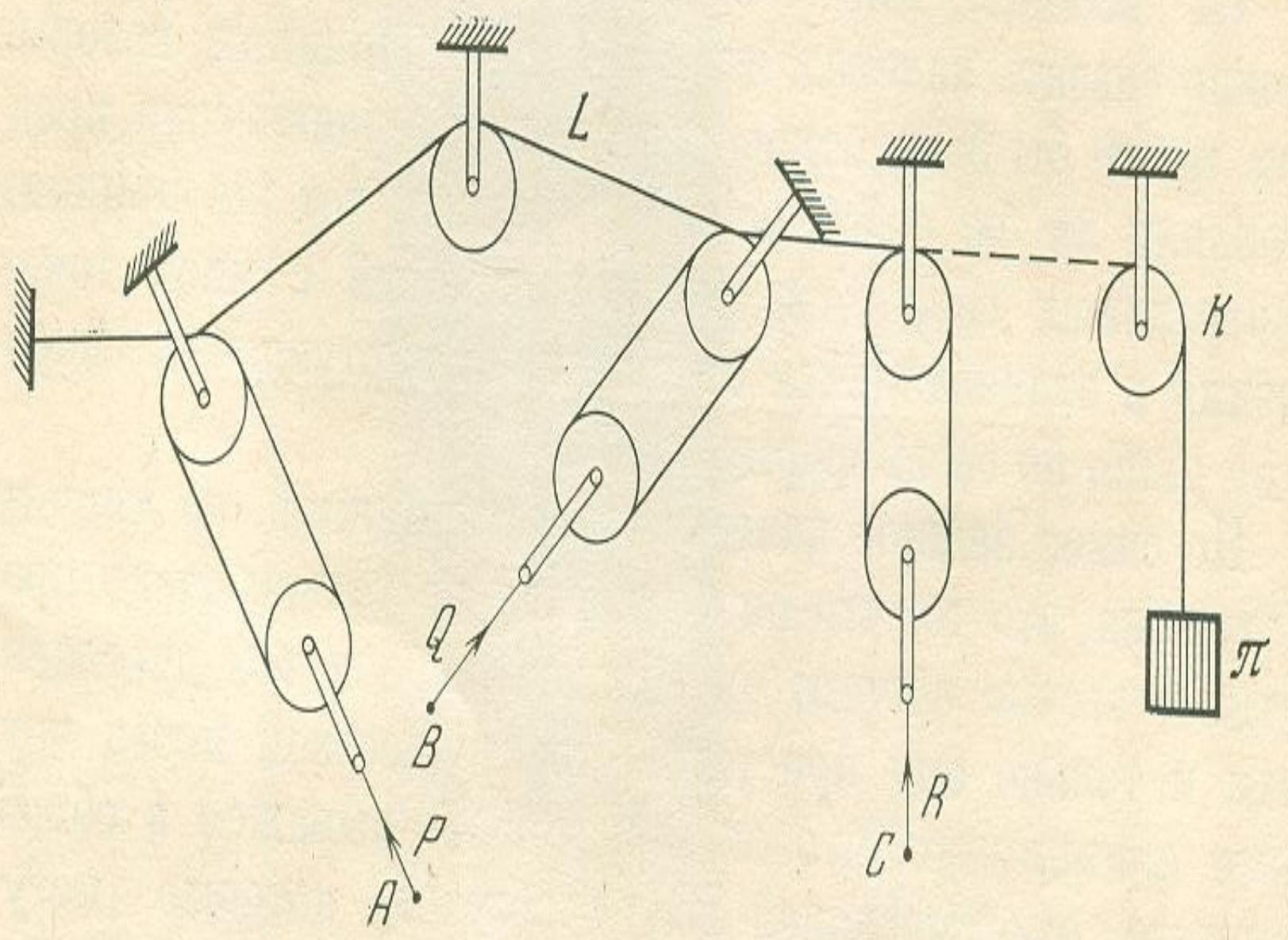
Лагранж обозначает через  $\alpha, \beta, \gamma \dots$  возможные бесконечно малые смещения точек системы вдоль линии действия сил  $P, Q, R \dots$ . Тогда высота  $h$ , на которую груз мог бы опуститься, выражалась бы так:
