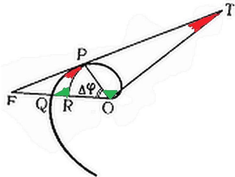
Подкасательной называется второй катет  $OT$  прямоугольного треугольника  $POT$ , где катет  $PO$  – радиус-вектор, соединяющий заданную точку  $P$  с полюсом  $O$ , а гипотенуза  $PT$  – отрезок искомой касательной.
